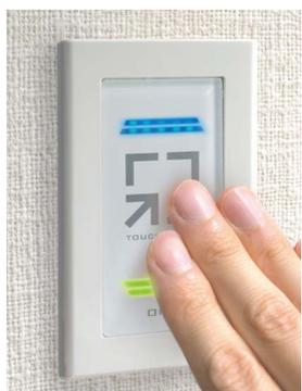
TSW-2は、静電容量式のタッチセンサーを搭載し、パネル中央のセンサー部に軽く指を触れるだけで動作する静電容量式のタッチスイッチです。摩擦や振動の影響を極めて受けづらく、耐久性に優れています。電源表示灯と出力表示灯によって、スイッチの状態が一目で把握できます。
